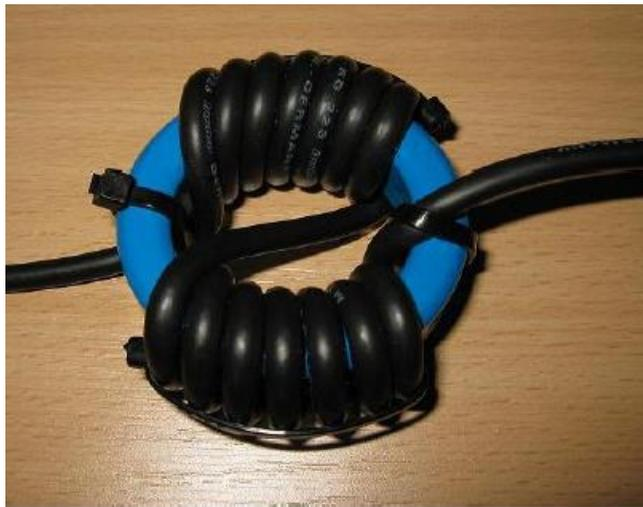
*Zusatzinformationen zum Betreiben einer FD 4 Antenne. Dieser Balun besteht aus einer Kombination von einem **Spannungs- und Strombalun**.*
