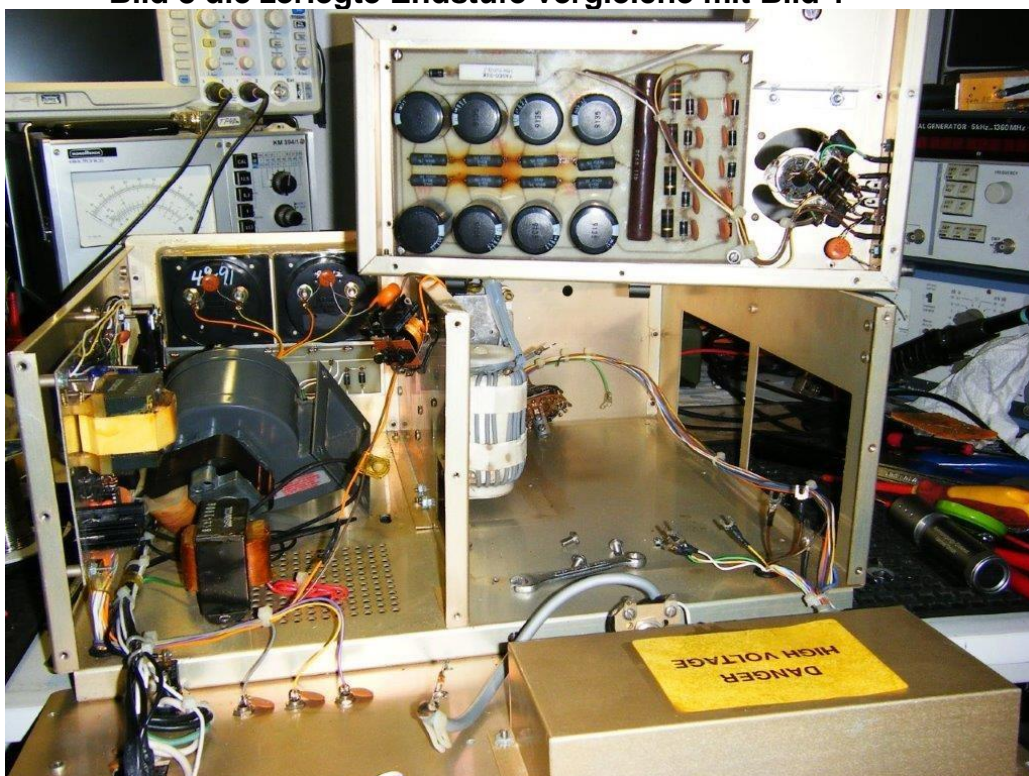
Bild 8 die zerlegte Endstufe vergleiche mit Bild 1
